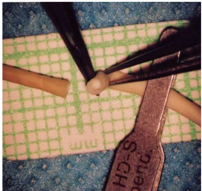
Resim2 : İç ve çevre kısımdaki lateks dokuların uzaklaştırılması sonrasında elde edilen tüp
